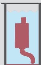
Immissione del filtro, in posizione verticale, in vasca (alta e stretta) riempita con Fap Cleaner. Il livello del liquido deve coprire oltre 10 cm il livello involucro fap/dpf e stazionamento in immersione da 50 min (per filtri parzialmente otturati) Fino a qualche ora (per filtricompletamente otturati).
